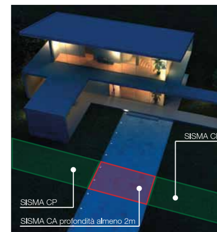
Fig. 2 - Zona di rivelazione pari alla larghezza del passaggio ed estesa almeno 2 metri nella direzione dell'attraversamento.
