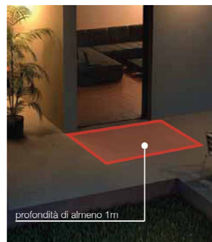
Fig. 1 - Zona di rivelazione pari alla larghezza dell'apertura e con profondità di almeno 1 metro.
