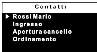
Per cambiare un nome e la suoneria associata occorre selezionare il nome usando i tasti ▼▲ e premere OK; si visualizza etichetta e suoneria.
