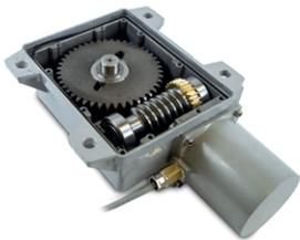
Motoriduttore con vite senza fine in acciaio e corona in bronzo, lubrificato con grasso a bassa viscosità in grado di garantire una vita utile prolungata e un tasso di usura ridotto.
