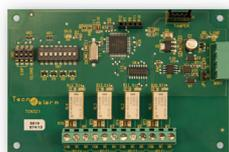
Modulo espansione uscite seriale, dotato di 4 uscite relè di segnale di tipo bistabile. Contatti in scambio libero, corrente nominale 0,3A 24V DC. Tutte le uscite sono liberamente programmabili. Autoprotezioni: predisposizione tamper, manomissione bus. Collegamento del modulo di espansione su Serial Bus RS485.
