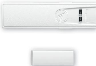
Rivelatore perimetrale per interni, wireless bidirezionale. Contatto magnetico per la protezione di aperture, porte e finestre. Massima versatilità d'installazione grazie al doppio reed interno. Completa gestione RSC®: programmazione, telegestione e controllo. Batteria di alimentazione al litio in dotazione. Autoprotezioni: apertura, rimozione, sopravvivenza. Classe ambientale II. Contenitore ABS. Colori disponibili bianco o marrone.
