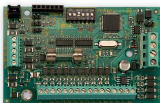
Modulo di espansione ingressi/uscite seriale, dotato di 4 ingressi zona e di 14 uscite. Gli ingressi consentono il cablaggio di rivelatori Tecnoalarm RDV® e di rivelatori convenzionali. Le 14 uscite disponibili di tipo open collectors sono liberamente programmabili. Autoprotezioni: predisposizione tamper, manomissione bus. Collegamento del modulo di espansione su Serial Bus RS485.
