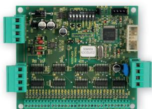
Modulo di espansione uscite seriale, dotato di 32 uscite open collector. Delle 32 uscite disponibili è possibile utilizzarne un massimo di 16. Tutte le uscite disponibili sono liberamente programmabili. Autoprotezioni: predisposizione tamper, manomissione bus. Collegamento del modulo di espansione su Serial Bus RS485.
