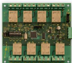
Modulo espansione uscite seriale, dotato di 8 uscite relè di potenza di tipo bistabile. Contatti in scambio libero, corrente nominale 4A 250V AC. Tutte le uscite sono liberamente programmabili. Autoprotezioni: predisposizione tamper, manomissione bus. Collegamento del modulo di espansione su Serial Bus RS485.
