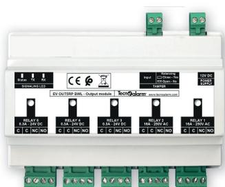
Modulo espansione uscite wireless bidirezionale, dotato di 5 uscite relè di tipo bistabile, di cui 3 uscite relè di segnale (contatto 0,3A 24V DC) e 2 uscite relè di potenza (contatto 16A 250V AC).
