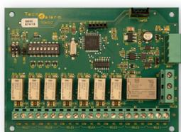
Modulo espansione uscite seriale, dotato di 8 uscite relè di tipo bistabile, di cui 7 uscite relè di segnale (contatto 0,3A 24V DC) e 1 uscita relè di potenza (contatto 4A 250V AC). Uscite liberamente programmabili. Autoprotezioni: predisposizione tamper, manomissione bus. Collegamento del modulo di espansione su Serial Bus RS485.
