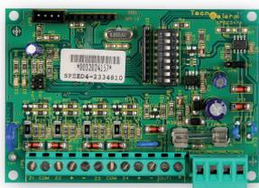
Modulo di espansione ingressi/uscite seriale, dotato di 4 ingressi zona e di 1 uscita. Gli ingressi consentono il cablaggio di rivelatori Tecnoalarm RDV® e/o rivelatori convenzionali. L'uscita disponibile di tipo open collector è liberamente programmabile. Autoprotezioni: predisposizione tamper, manomissione bus. Collegamento del modulo di espansione su Serial Bus RS485.
