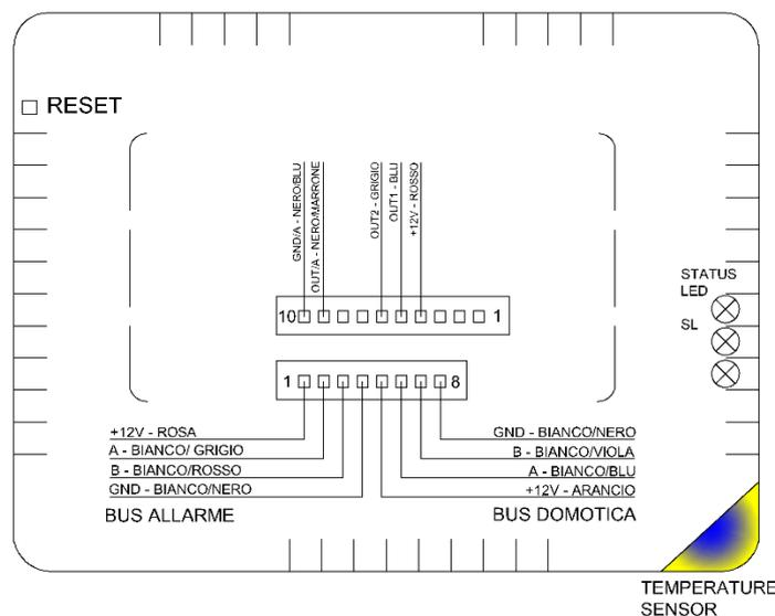
**RESET:** Dalle fessure laterali è possibile agire sul pulsante di Reset che forza il riavvio del dispositivo.
