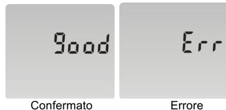
Dalla schermata di visualizzazione predefinita, per entrare in modalità di configurazione tenere premuto il pulsante per 3 secondi. All'accesso viene richiesto la password di conferma. Quando non si è in configurazione premere il pulsante per selezionare il parametro da modificare.
